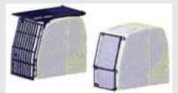
КАБИНА С FOPS ИЛИ ПЕРЕДНИЕ ЩИТКИ Для дополнительной безопасности при определенных работах.
