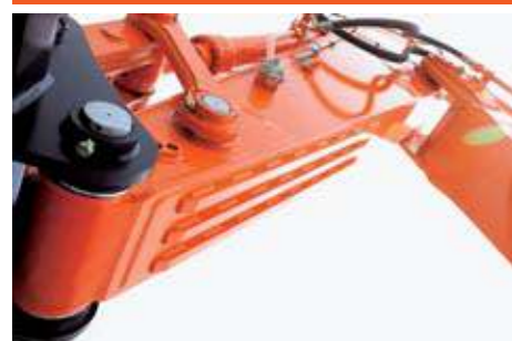
Усиленная стрела, рукоять и цилиндры
