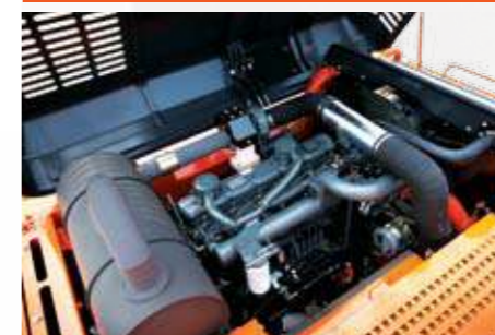
Двигатель механического типа с высокоэффективными фильтрами
