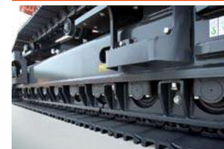
Полное ограждение гусеницы и полностью усиленные части шасси
