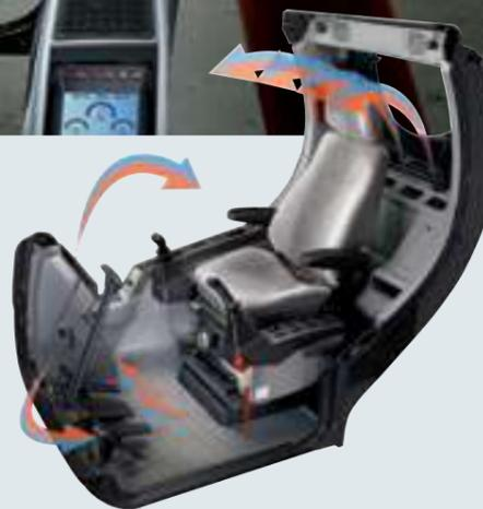
Высокоэффективный кондиционер воздуха обеспечивает изменяемый воздушный поток, автоматически регулируемый в зависимости от условий. Пять режимов работы позволяют удовлетворить даже самых требовательных операторов.
