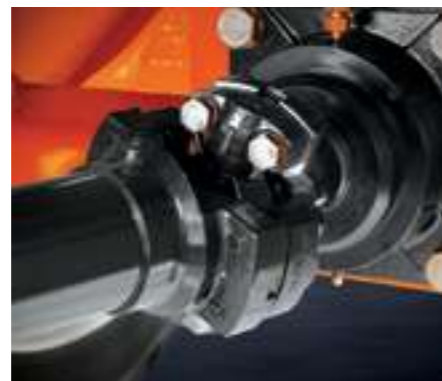
Карданный вал Защитная крышка установлена для защиты сальника от пыли, посторонних предметов и преждевременного износа.
