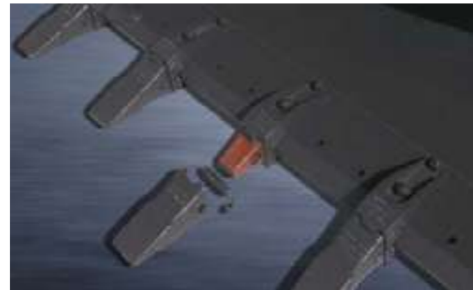
Зуб из двух частей (часть, надеваемая на палец, и адаптер с болтовым креплением)
