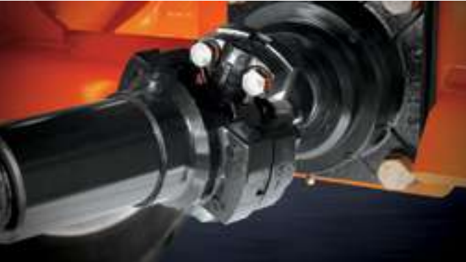
Карданный вал Защитная крышка установлена для защиты сальника от пыли, посторонних предметов и преждевременного износа.
