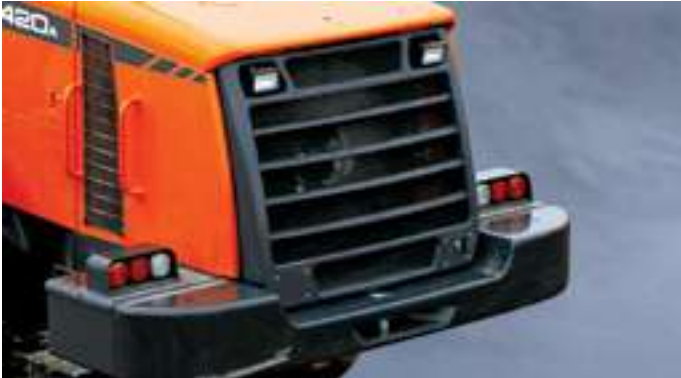
Решетка радиатора (Стальная конструкция)
