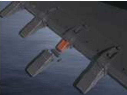
Зуб из двух частей (часть, надеваемая на палец, и адаптер с болтовым креплением)
