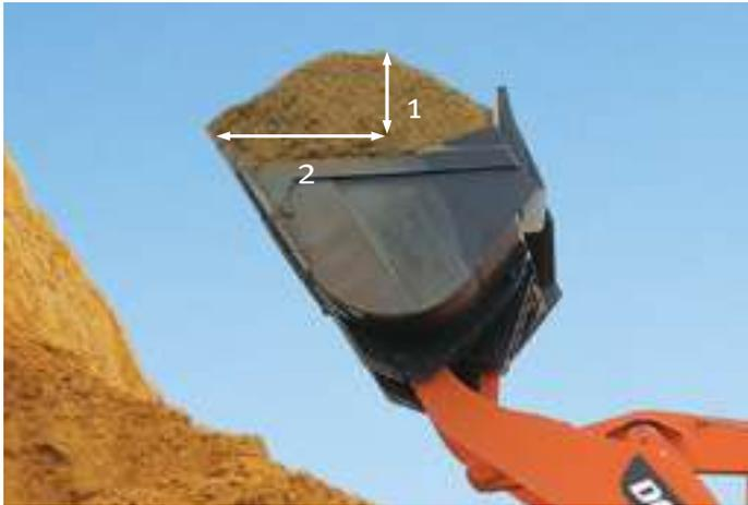
**ГЕОМЕТРИЧЕСКАЯ ВМЕСТИМОСТЬ** – это объем содержащейся в ковше после того, как груз выравняется с помощью линейки, лежащей на режущей кромке и задней части ковша.
