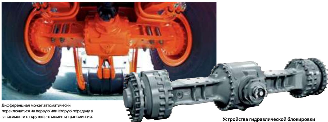
Дифференциал может автоматически переключаться на первую или вторую передачу в зависимости от крутящего момента трансмиссии.
