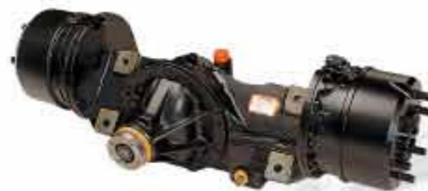
Шплинтованные соединения шестерней позволяют передавать большой врачающий момент на ведущие колёса.
